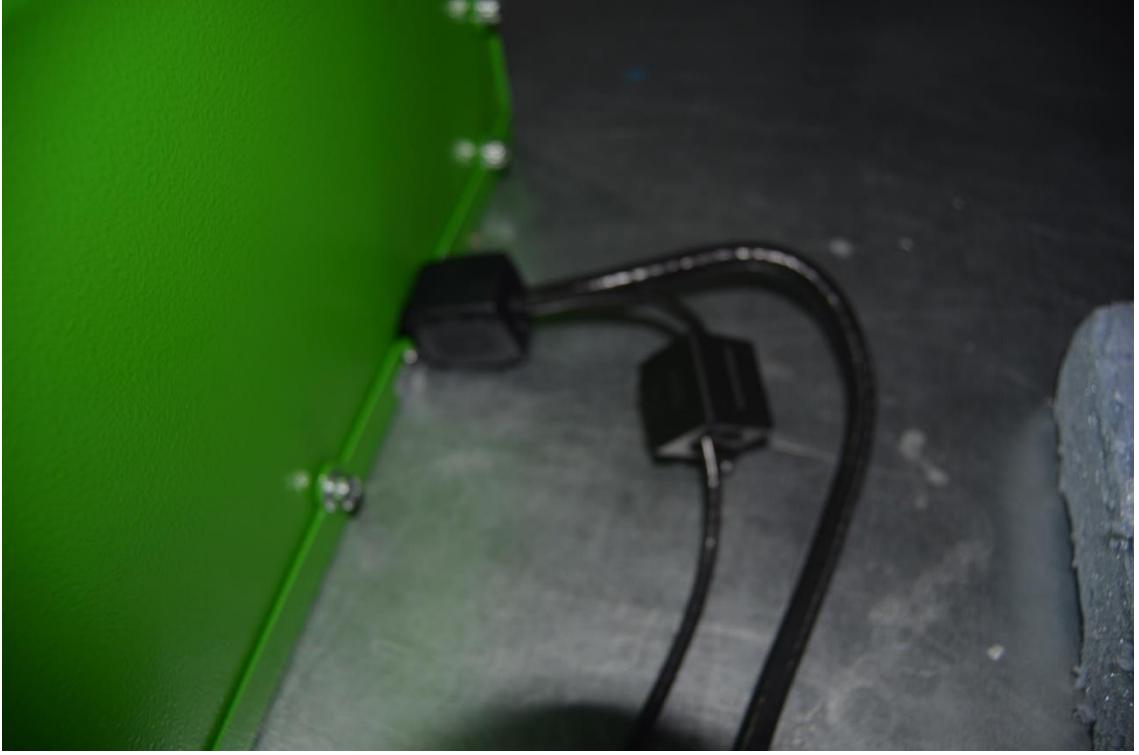
Resim 4: DGC'ye takılan ferritler / Picture 4: EUT inserted ferrites
