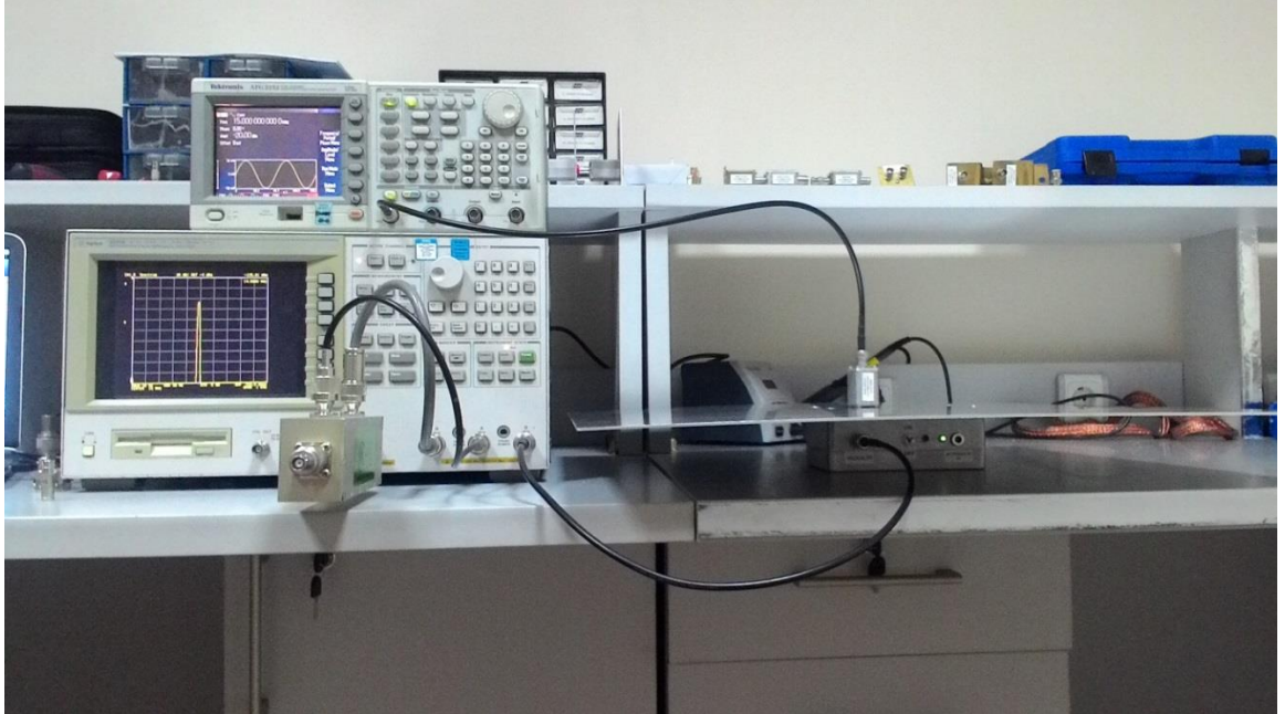
Resim 7: RE102 Rod Anten Araya Girme Kaybı Ölçüm Düzeneği /
